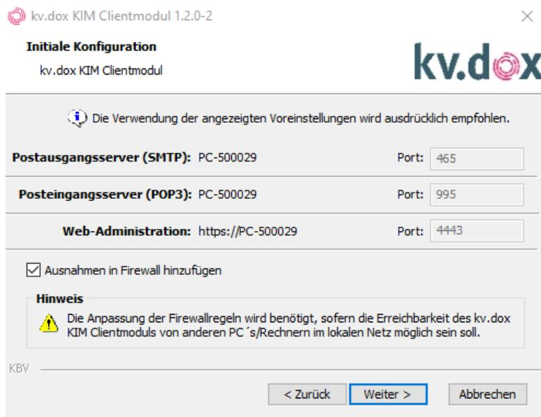
Abbildung -5: Zuweisung der Ports
